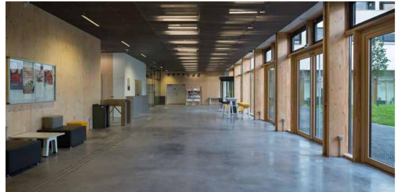
▲ Dans un souci de cohérence, l'architecte a laissé apparents les bois de structure. Les faux plafonds des circulations et du hall d'entrée sont traités avec du métal déployé qui laisse deviner les réseaux techniques.
